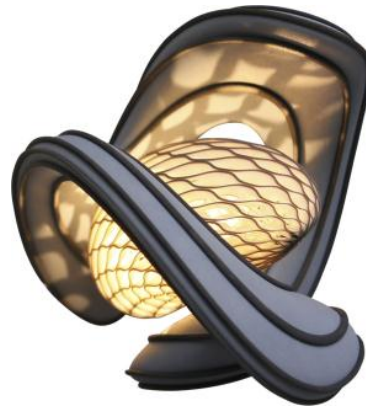
Protótipo de Lâmpada Criado em uma Impressora 3D Objet Connex Multi-Material. Cortesia de Patrick Gunther.
